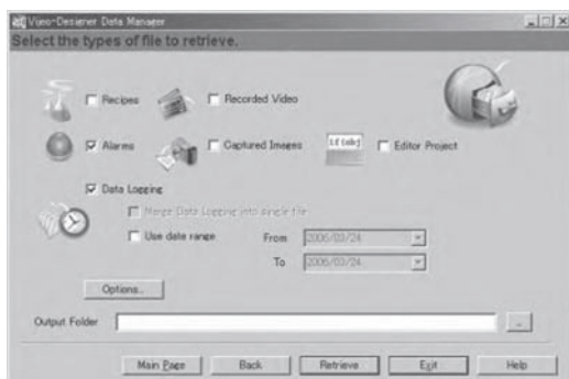
Data Manager: для передачи рецептов, видео, изображений и т.д., простым щелчком мыши через Ethernet или USB
