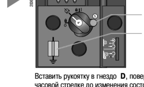
Вставить рукоятку в гнездо **D**, повернуть по часовой стрелке до изменения состояния указателя **F**
