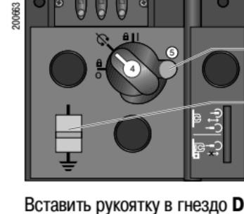
Вставить рукоятку в гнездо **D**, повернуть по часовой стрелке до изменения состояния указателя **F**
