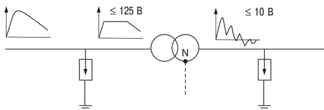
**Рис. 12.** Ограничение и трансформация перенапряжений, вызванных разрядами молнии
