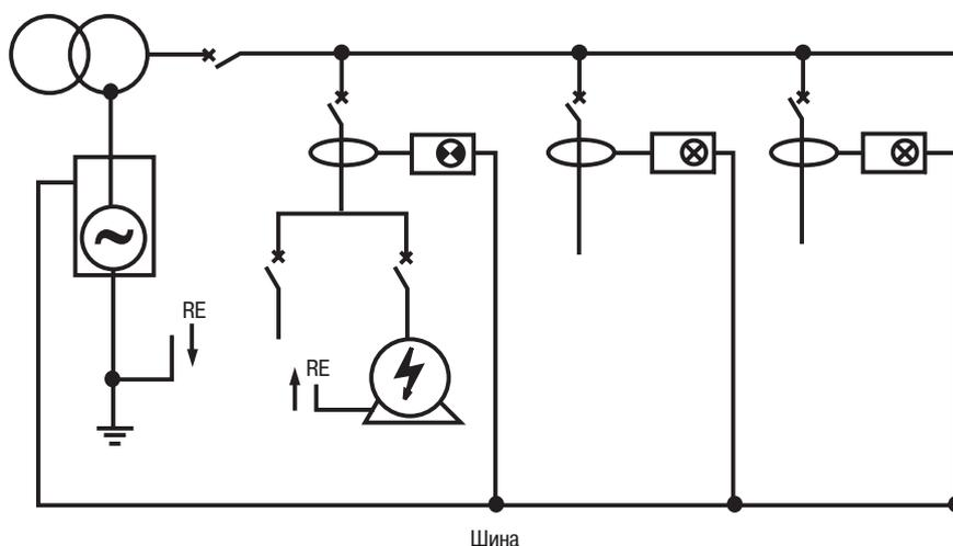
Ток определяющий место замыкания протекает по проводникам и обнаруживается датчиком тока. В цепи каждого электроприемника установлены избирательные усилительные блоки (настроены на частоту и фазу тока, предназначенного для определения места замыкания), которые вычисляют активное сопротивление и емкость цепи (с учетом информации о напряжении и фазе, получаемой через шину) и указывают на наличие замыкания
