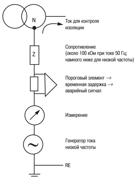
**Рис. 17.** Функциональная схема устройства контроля состояния изоляции (IMD)
