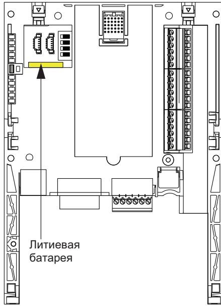
Перед установкой карты в преобразователь частоты необходимо убедиться, что батарея резервного питания вставлена в карту. Она представляет собой квадратный модуль, который фиксируется на модуле оперативной памяти RAM (см. рисунок).
