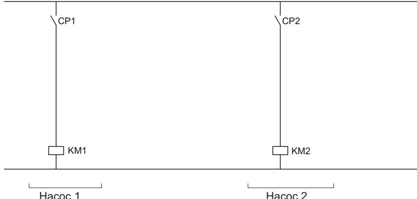
Для насосов от 3 до 5, схема повторяется, с увеличением индексов обозначений (KMx, CPx).
