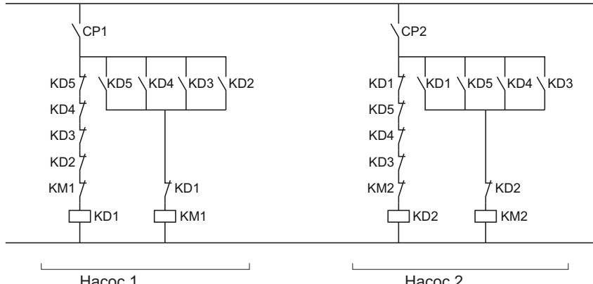
Для насосов от 3 до 5, схема повторяется, с увеличением индексов обозначений (KDx, KMx, CPx).
