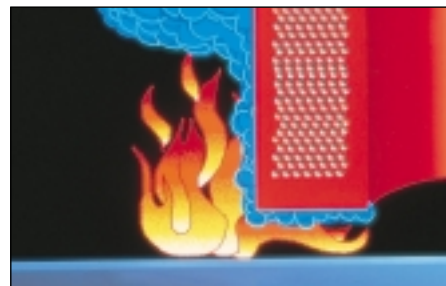
2-й противопожарный эффект: образование преграды из водяного пара
