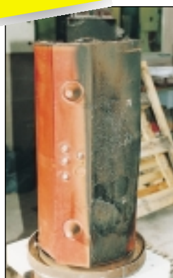
Катушка трансформатора Trihal после испытания F1
